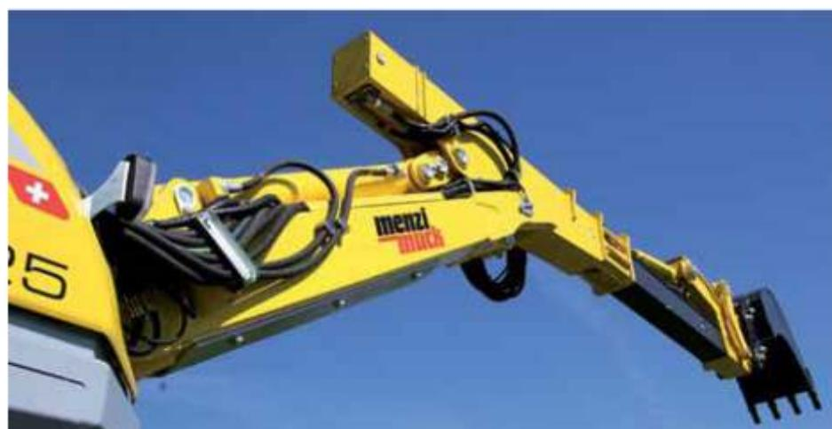
**Tool management:** Zařízení pracující s údaji o množství průtoku a tlaku hydraulického oleje dodávaného pro příslušenství stroje. Požadované parametry mohou být uloženy na displeji, a to celkem až pro 15. nástrojů. Jednoduše vyberete předprogramované parametry pro dané příslušenství.
