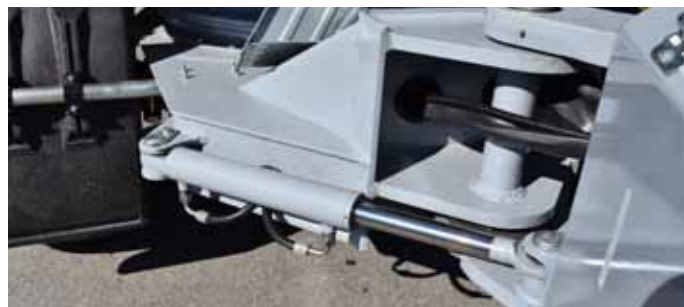
Robusní centrální kloub s úhlem ohybu +/- 35° a +/- 12° úhlem naklonění
